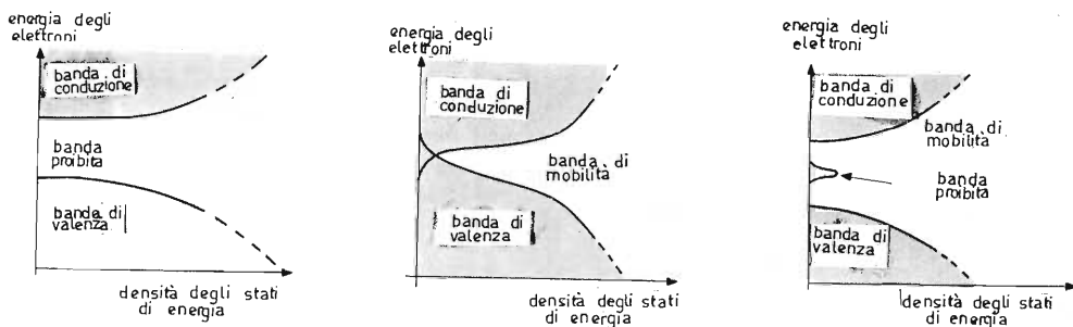
Fig. 1 - I modelli di bande. I modelli rappresentano i semiconduttori, siano essi cristallini o amorfi, possono essere simbolizzati da grafici indicanti il numero di elettroni situati in un dato livello di energia. Per un semiconduttore convenzionale (a), si distingue la banda di valenza, a partire dalla quale un elettrone può essere inviato verso la banda di conduzione, separata dalla banda di valenza dalla banda proibita. La densità dell'energia indica il numero di elettroni di energia fissa, in un dato volume di materiale semiconduttore. Nel modello di Ovshinsky (b), per i se-
